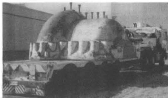
写真3 高圧タービンハウジングの輸送
